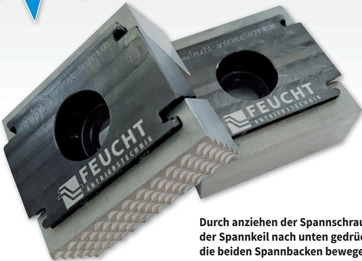
Durch anziehen der Spannschraube wird der Spannkeil nach unten gedrückt und die beiden Spannbacken bewegen sich nach außen und spannen das Werkstück.
